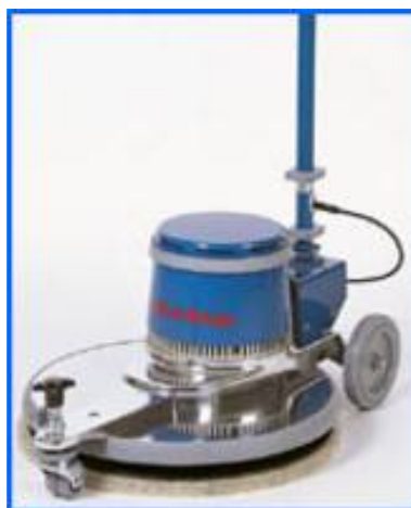
Wypolerowanie materiału StoDivers P 105 za pomocą miękkiego pada
